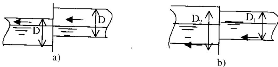
Hình 2.4: Nối ống, cống thoát nước sinh hoạt trong các giếng thăm
